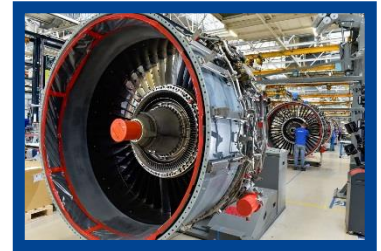
Ligne de montage des modules fan du LEAP
