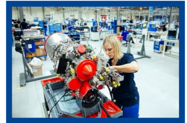
Ligne d'assemblage de l'Arriel 2D
