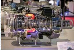
**Élargissement et renouvellement de la gamme Turbomeca : Arrius 2R, Arrano, Ardiden 3C/3G, RTM322**
